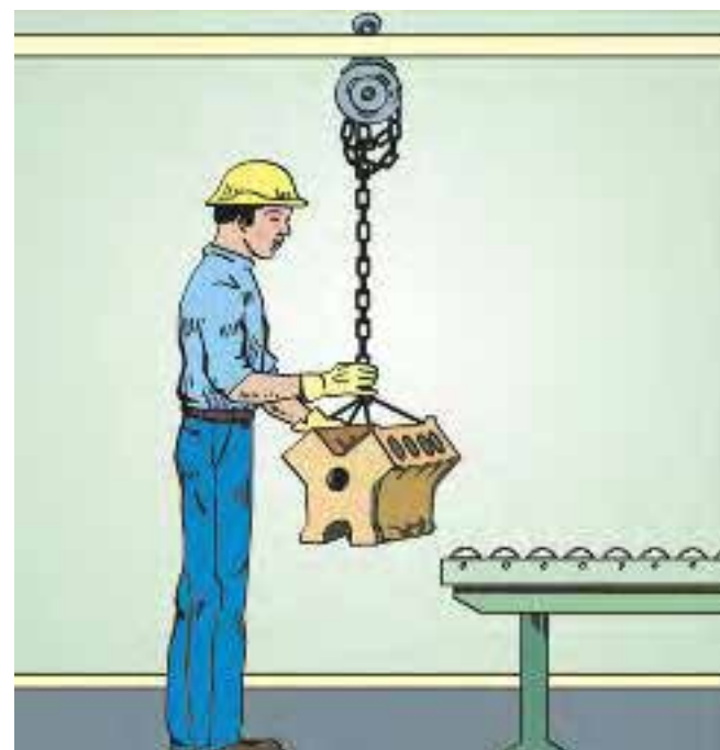
شکل ۹-۴: مطمئن شوید که حداکثر بارکاری ایمن کاملاً مشخص باشد.
