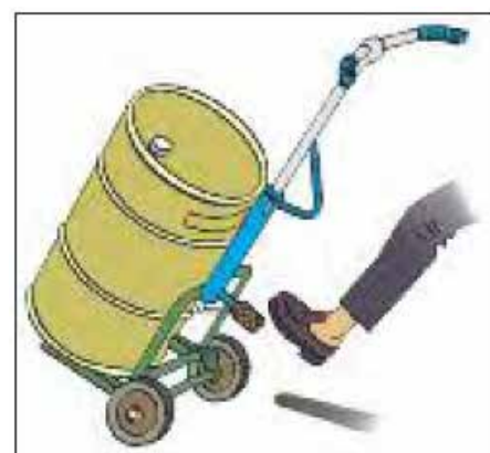
شکل ۶-۳: وسیله جابه جایی بشکه نه تنها کار را آسانتر می کند بلکه به جلوگیری از آسیب کمک می کند.
