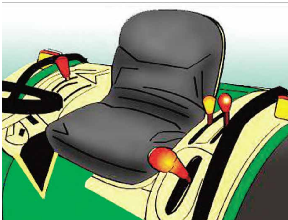
شکل ۶۳-۱: ترتیبی دهید تا صندلی، فضای پا و کنترل ها برای رانندگی اپراتور ایمن و راحت باشد.
