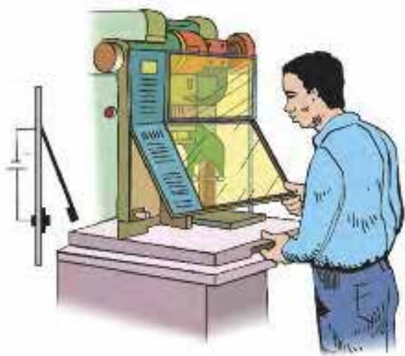
شکل ۴۸-۳: اهرم پایی فعال یک حفاظ اینترلاک یا متوقف کننده شکل ۴۸-۲: حفاظ اینترلاک با وسیله قطع کننده داخلی
