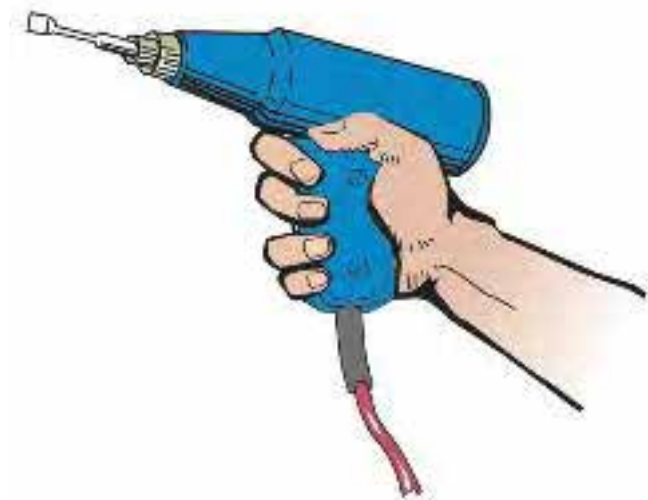
شکل ۱۹-۱: نمونه ای از ابزار با کلید ماشه ای بلند که می توان محکم در دست گرفت.
